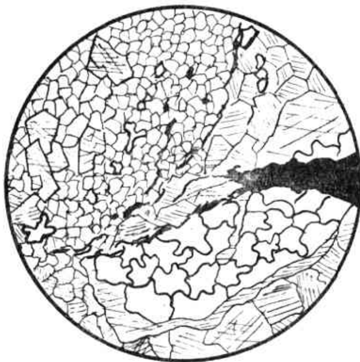
obr. č. 2 — šedý břidličnatý vápenec. Heterogranoblastická struktura. Je tvořena jemnozrnnou kalcitovou hmotou, vedle které se v podstatné míře uplatňují větší sekundární kalcitová zrna. Místy je kalcit nahrazen laločnatými zrny epigenetického křemene. Vápenec dále obsahuje četná drobná zrna klastického křemene a shloučené nebo jemně rozptýlené černé šupinky grafitu, pyritu a limonitu. Zvětšeno 100 krát, nikoly II.
