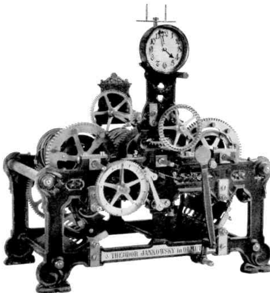
Stroj věžních hodin, výrobce L. Hainz, Praha, dodavatel T. Jankowsky, Olomouc, 1902 (Foto: P. Rozsival)
